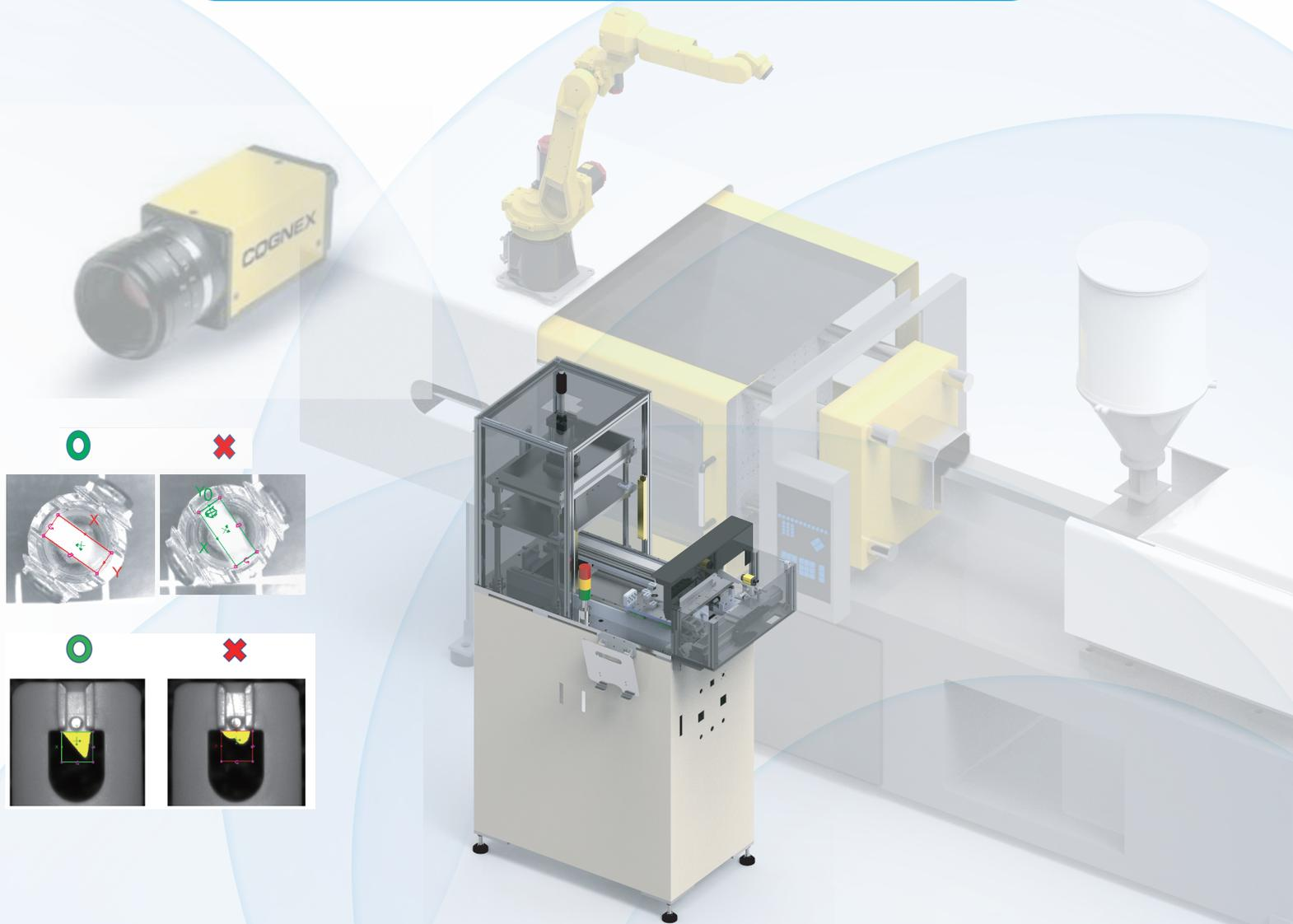
設備連線塑膠射出成型機，執行AOI系統自動量測全檢，強化品質競爭力。
